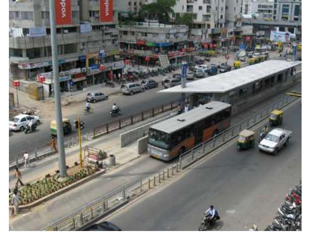
આકૃતિ ૧.૪ મિશ્ર પ્રકારના ટ્રાફિકની લેનની તુલનાએ એક અલાયદી બસ લેન અનેકગણા વધુ લોકોની અવરજવરની ક્ષમતા ધરાવે છે.
